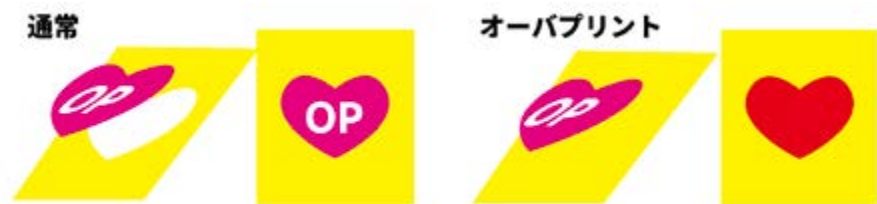
オーバープリントを使用していない重なり合ったオブジェクトとテキスト
